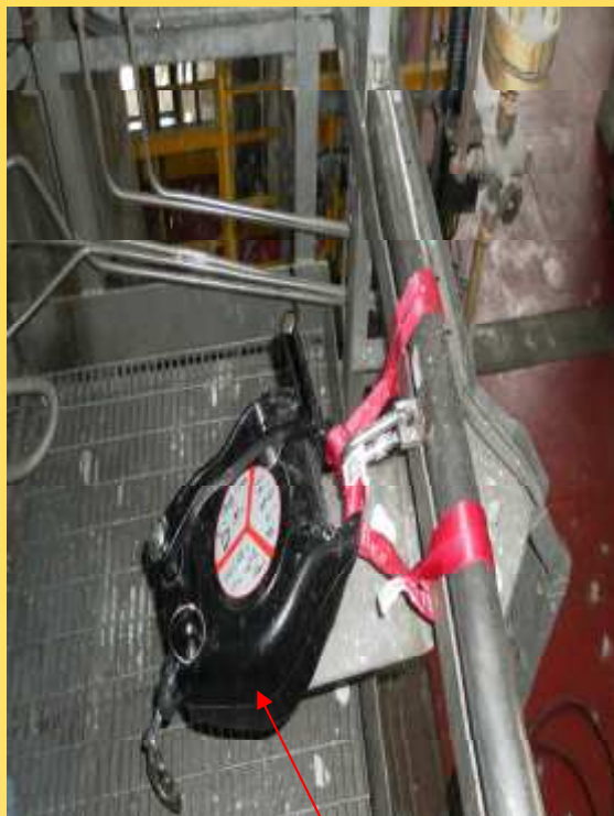
Verricello di recupero (EN 360) con adeguato ancoraggio (EN 795)
