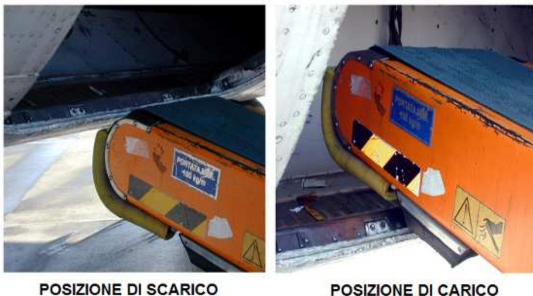
Figura 4-6 – Posizionamento nastro di carico.
