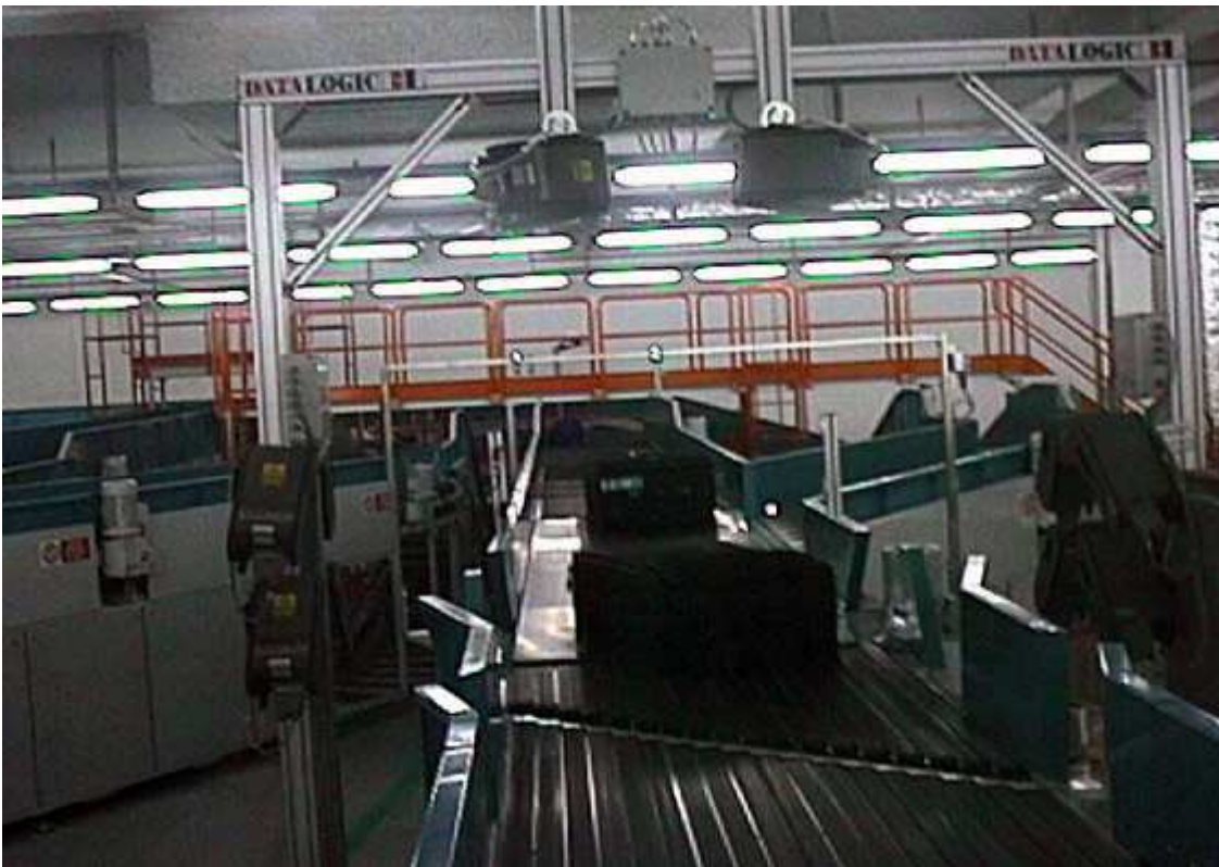
Figura 3-2 – Esempio di sistema di lettura etichette automatico.
