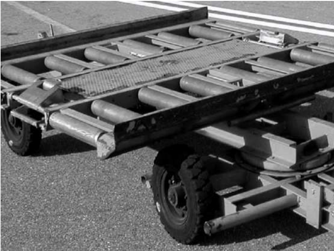
Figura 3-7 – Esempio di "baggage dolly".
