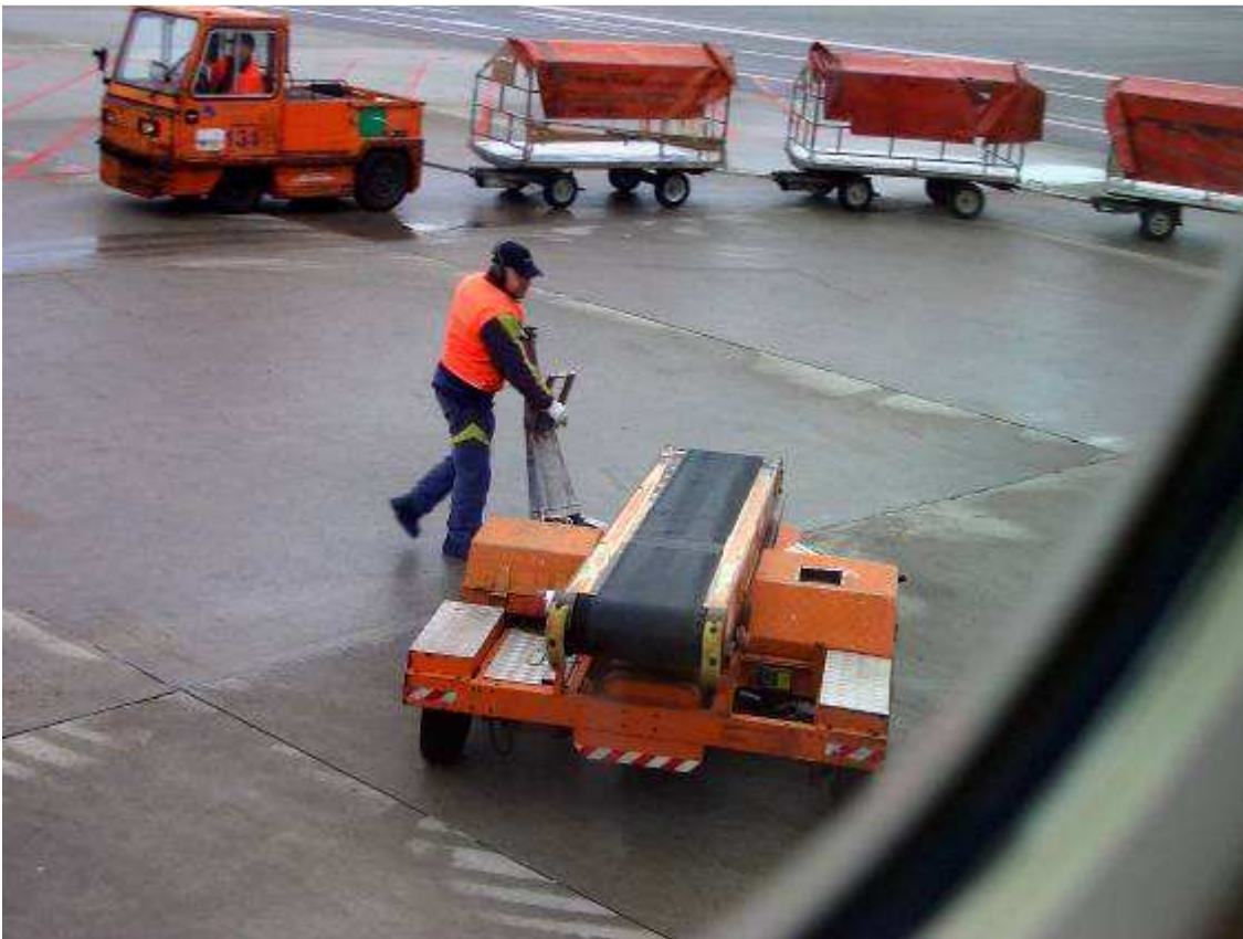
Figura 4-2 – Trattorino con dolly e nastro di carico.
