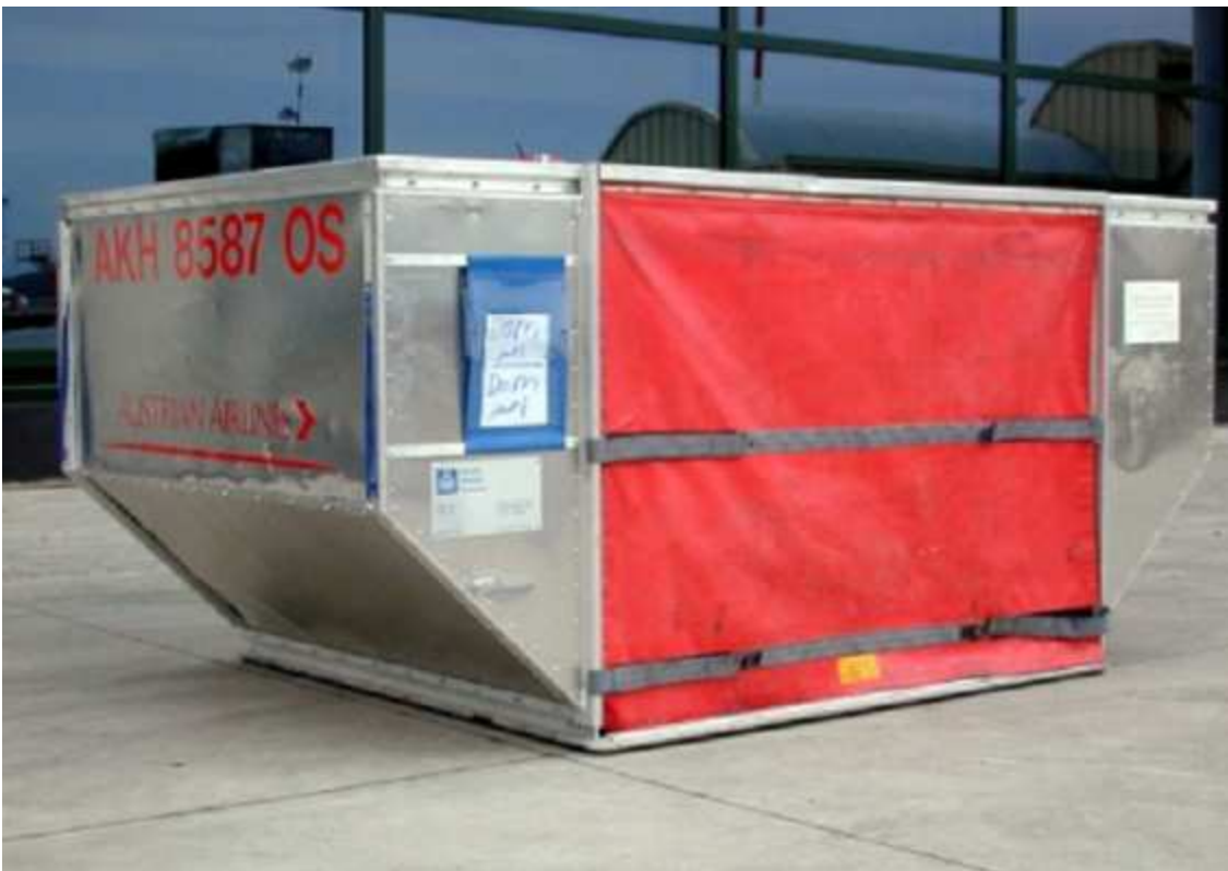
Figura 3-6 – Esempio di ULD (Unit Load Device): igloo.
