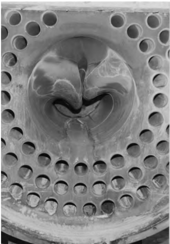
c) Focolare caldaia tubi da fumo
