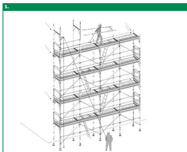
1. Esempio di procedura di montaggio del ponteggio.
